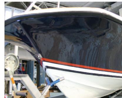
Polieren und wachen verzögert diese Erscheinung nicht nachhaltig und so wird es schließlich zum Schutz des GFK und zur Farbauffrischung nötig sein, die Oberfläche zu lackieren.
