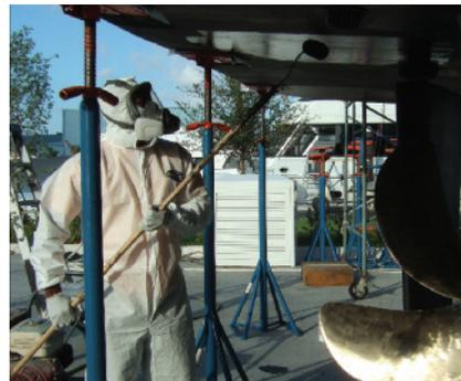
Viele Werften und Hersteller bieten das Osmoseschutzsystem von International als zusätzliche Serviceleistung an – fragen Sie danach. Ein Osmoseschutzsystem kann einen bereits begonnenen osmotischen Prozess nicht stoppen. Bei älteren Booten sollte daher vor der Beschichtung der Feuchtigkeitsgehalt des Laminats gemessen werden.
