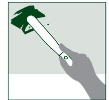
Nach der Aushärtung schleifen Sie den Watertite mit 80-220er Papier. Die Spachtelfläche sollte dann glatt und auf Niveau der Oberfläche sein. Wenn nötig wiederholen Sie den gesamten Vorgang. Abschließend kann die Reparaturfläche grundiert werden.
