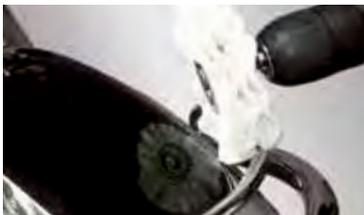
Wir empfehlen die Kombination von Polierrüchern verschiedener Tuchqualitäten und Polierpasten. Bitte beachten Sie, dass Polieren stets mit Paste durchgeführt werden sollte.
