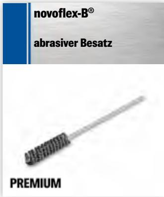
Flexibles, selbst zentrierendes Honwerkzeug. Erzeugt Plateau-Finish. Durch Kreuzschliff guter Träger für Ölfilmhaftung.
