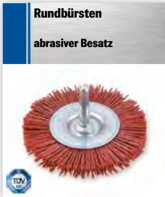
Der Besatz dieser Bürsten passt sich ideal den Konturen des Werkstücks an, ohne die Oberfläche wesentlich zu verändern. Es wird immer wieder neues Schleifkorn freigesetzt, so dass die Abtragsleistung konstant bleibt.
