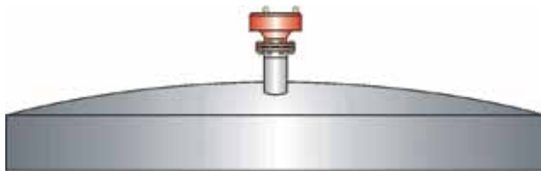
Bild 1: Freie Ent- und Belüftung des Lagertanks mit PROTEGO® EH/OS
