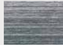
Schleifmoprad mit Korn 40 lange durchgehende Linienstruktur, minimale Vertiefungen, glattes Finish
