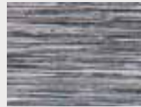
Schleifband mit Korn 40 kurze markante Linienstruktur, raue Oberfläche, kontrastreiches Finish
